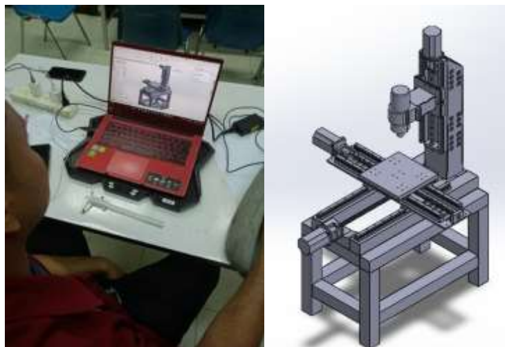
ภาพที่ 1 แสดงนักวิจัยกำลังออกแบบเครื่องกัดซีเอ็นซีขนาดเล็กแบบสามแกนด้วยโปรแกรม SolidWorks (ซ้าย) และแบบจำลองสามมิติของเครื่องต้นแบบที่ออกแบบแล้ว (ขวา)
