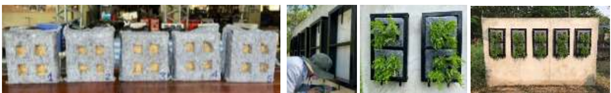
ก. ทำการหุ้มแผ่น Felt รอบแผ่นปลูกพืชสวนแนวตั้ง ข. ติดตั้งแผ่นปลูกพืชและพรรณไม้บนแผ่นปลูกพืชสวนแนวตั้งทั้ง 5 สูตร
