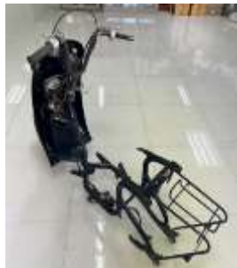
(ก) ถอดระบบเครื่องยนต์และระบบไฟ
