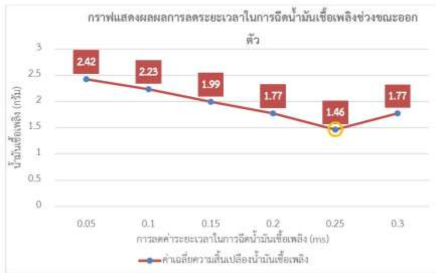
ภาพที่ 3 แสดงความสัมพันธ์ของระยะเวลาในการฉีดน้ำมันเชื้อเพลิงต่ออัตราการสิ้นเปลืองน้ำมันเชื้อเพลิงขณะการออกตัว
