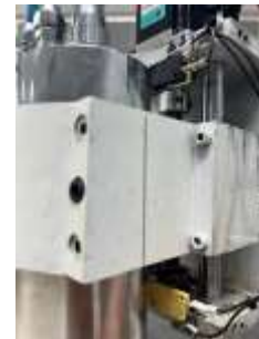
(ค) การติดตั้งลิ้มิตสวิตช์เพื่อ จำกัดขอบเขตแกน Z
