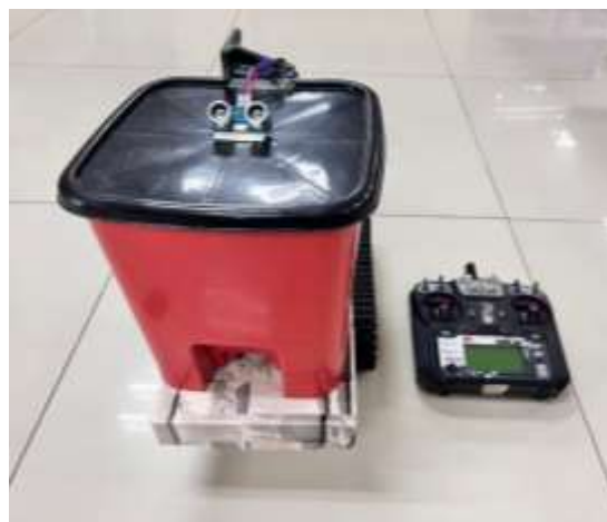
ภาพที่ 3 ถังขยะอัจฉริยะเคลื่อนที่อัตโนมัติด้วยระบบควบคุมระยะไกล
