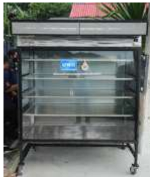
(ข) เครื่องอบแห้งพลังงาน แสงอาทิตย์ร่วมกับลมร้อน
