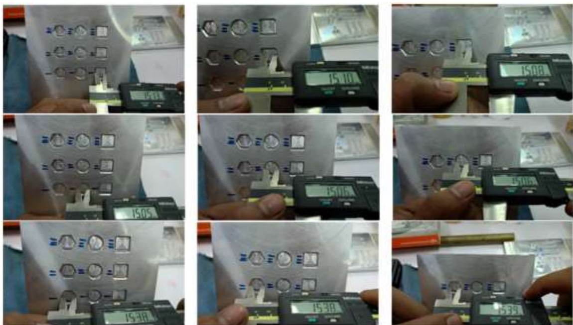
ภาพที่ 7 แสดงการวัดขนาดและเส้นผ่านศูนย์กลางของชิ้นงานที่มีรูปทรงเรขาคณิต
