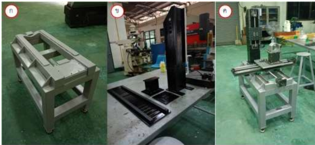
ภาพที่ 3 แสดงขั้นตอนการสร้างโครงสร้างต้นแบบของเครื่องกัดซีเอ็นซีขนาดเล็กแบบสามแกน
