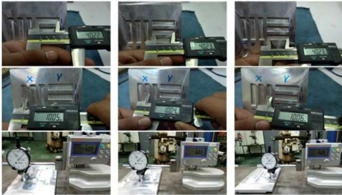
ภาพที่ 6 แสดงการตรวจสอบค่าความคลาดเคลื่อนของชิ้นงานจากการกัตามแนวก้นด้วยเครื่องกัตซีเอ็นซีขนาดเล็กแบบสามแกน
