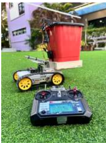
ภาพที่ 3 ถังขยะอัจฉริยะเคลื่อนที่อัตโนมัติด้วยระบบควบคุมระยะไกล
