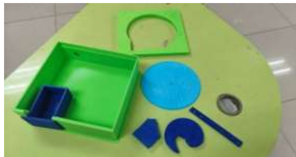
ภาพที่ 4 ส่วนประกอบของเครื่องนับยาอัตโนมัติผ่านเครื่องพิมพ์สามมิติ
