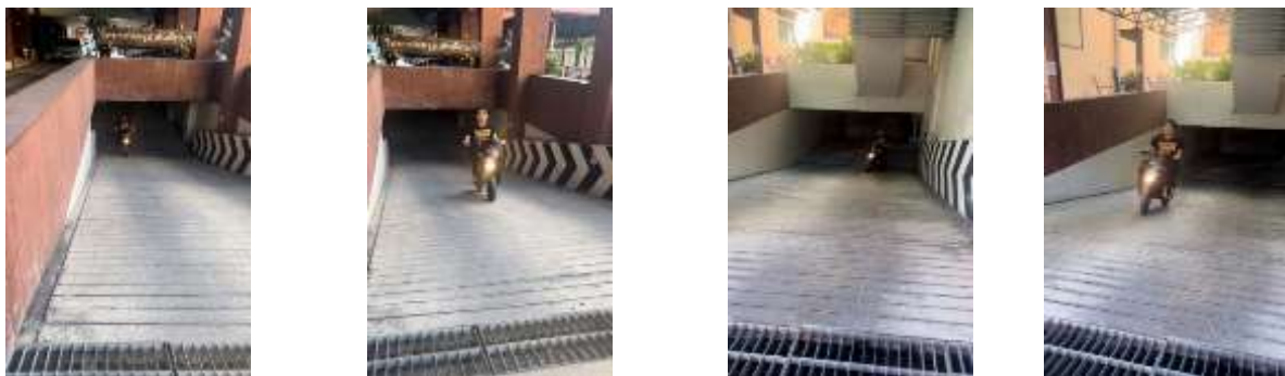
ภาพที่ 5 การขึ้นทางลาดชัน 13° คิดเป็น 23.09 %
