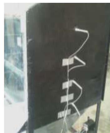
ภาพที่ 2 (ข) ตำแหน่งติดตั้ง Thermocouple
