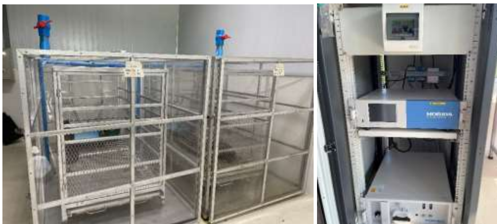
ภาพที่ 1 กรงทดลองวัดก๊าซรายตัวและเครื่องวัดปริมาณก๊าซ Horiba รุ่น Gas Analyzer VA-5000
