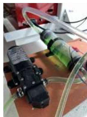
(ข) ปั้มน้ำและที่พักน้ำหล่อเย็น
