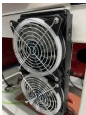
(ก) หม้อน้ำและพัดลมระบายความร้อน
