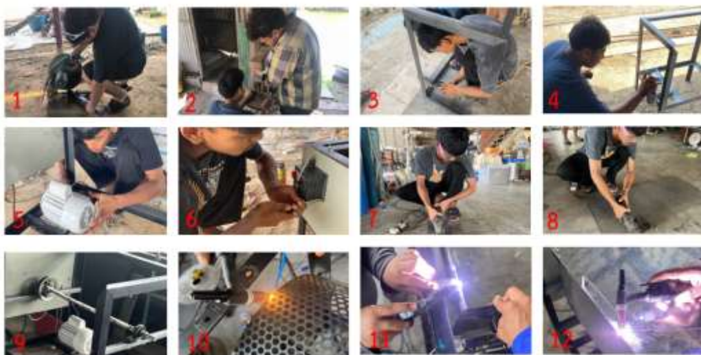
ภาพที่ 4 ขั้นตอนการสร้างเครื่องกะเทาะเปลือกกุ้งขาวตากแห้งสามารถแบ่งเป็นขั้นตอนได้ทั้งหมด 12 ขั้นตอน
