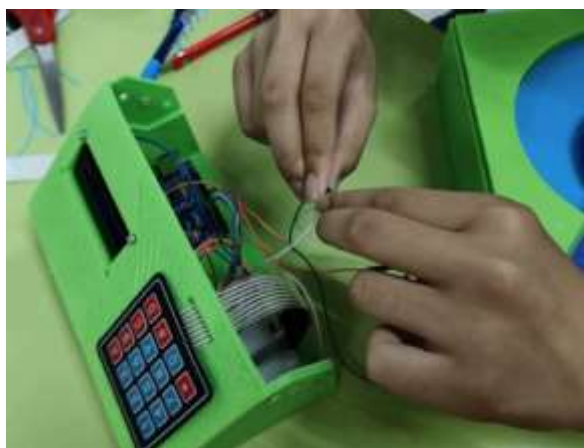
ภาพที่ 8 การเชื่อมต่ออุปกรณ์เข้ากับบอร์ดควบคุม Arduino UNO R3
